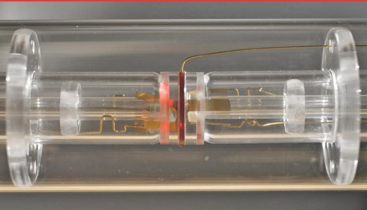
*Dettaglio della riproduzione di un campione di materiale all'interno delle camere a gas e a contatto con gli elettrodi a 5 poli in metallo nobile. Nella realtà le camere non sono trasparenti essendo in ceramica di allumina purissima. Tale materiale è utilizzato per la sua indeformabilità alle alte temperature.*
