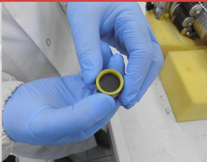
*Dettaglio di un nuovo campione di materiale durante il processo di inserimento all'interno delle camere a gas di Real Life Tester.*
