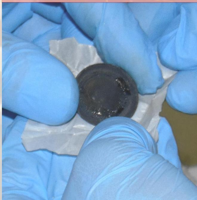
*Dettaglio di un campione di materiale estratto da Real Life Tester, visibilmente deteriorato a seguito di un ciclo di test.*
